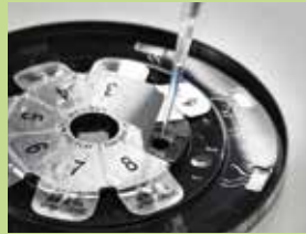
Proben und Reagenzien direkt in die Disc PIPETTIEREN.
